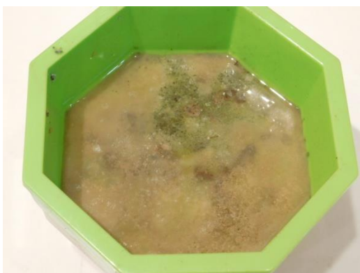
水道水で浸漬の表面（カビ多し）
